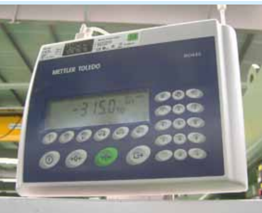
KOS 安装的是坚固耐用的 IND445 工业称重终端，最高支持 99 条皮重记录。该产品还提供可选的以太网 TCP/IP 接口，可与 IT 系统通讯。
