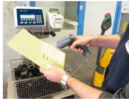
IND465 称重终端和耐用的 PBA330-B60 称重平台、条形码扫描仪以及标签打印机。
