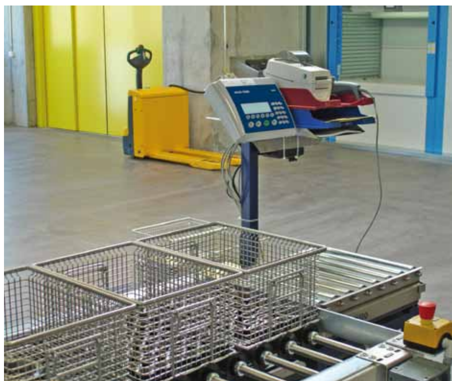
集成计数系统确保高效无错的产品储存
