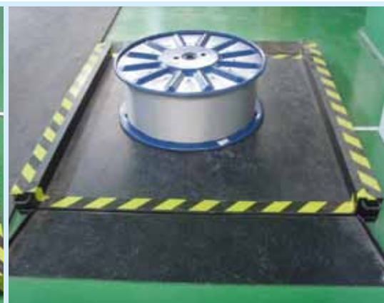
PUA579 超薄型平台秤最大称量范围为 1500kg，其超薄结构设计旨在满足液压搬运车的作业需要。平台秤坚固耐用，能够承受搬运车的整车负荷。
